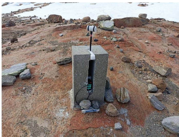
Рисунок 5 – Немагнитная тумба с установленным MMPOS-1 (март 2023 г.)
