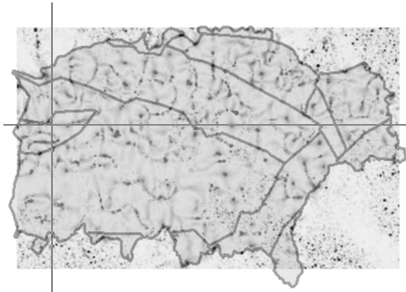
Рисунок 11 – Плановая кривизна поверхности подошвы четвертичных отложений (SAGA)
