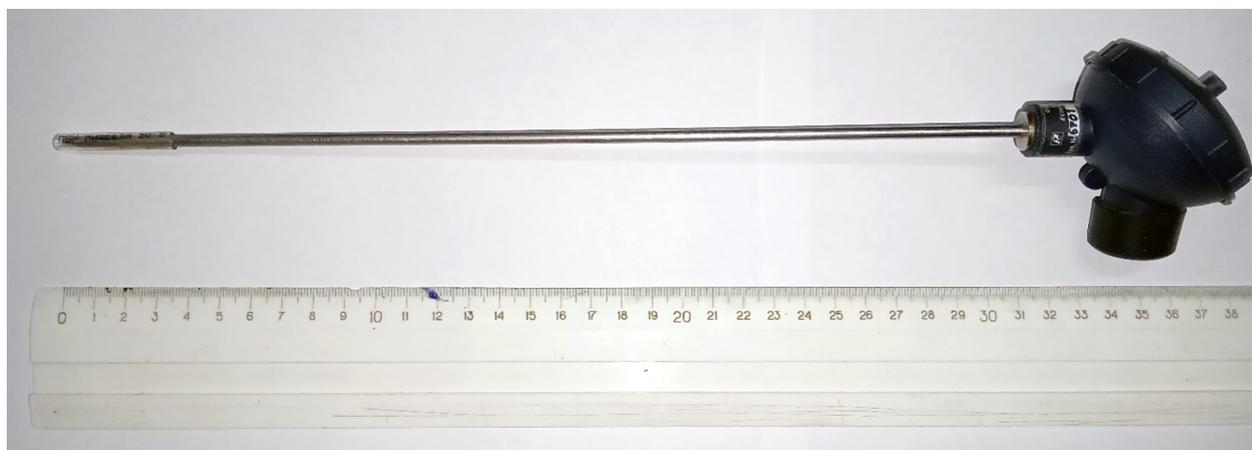
Рисунок 1 – Автономный регистрирующий термометр типа EClerk
