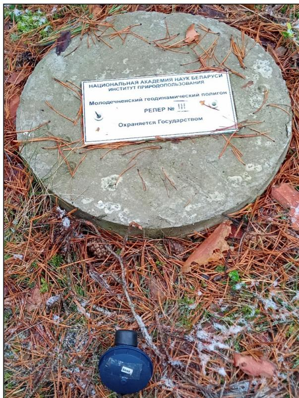
**Рисунок 7** – Стационарный пункт наблюдения с заглубленным термометром
