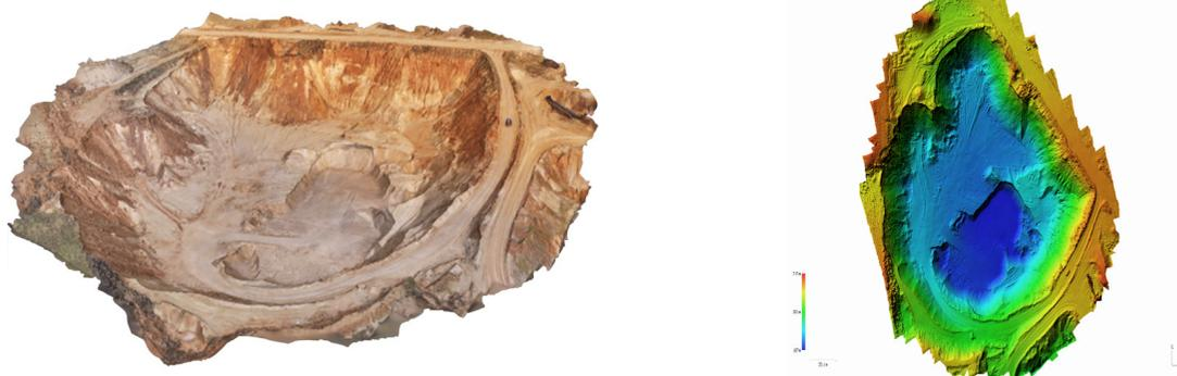
Рисунок 2 – Результаты обработки данных аэрофотосъемки в Agisoft Metashape
