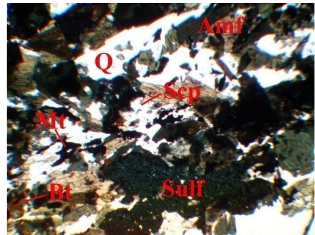
Рисунок 11 – Метасоматит эпидот-кварц-амфибол-плагиоклазовый с сульфидами, скв. Щ 7, гл. 257,2 м
