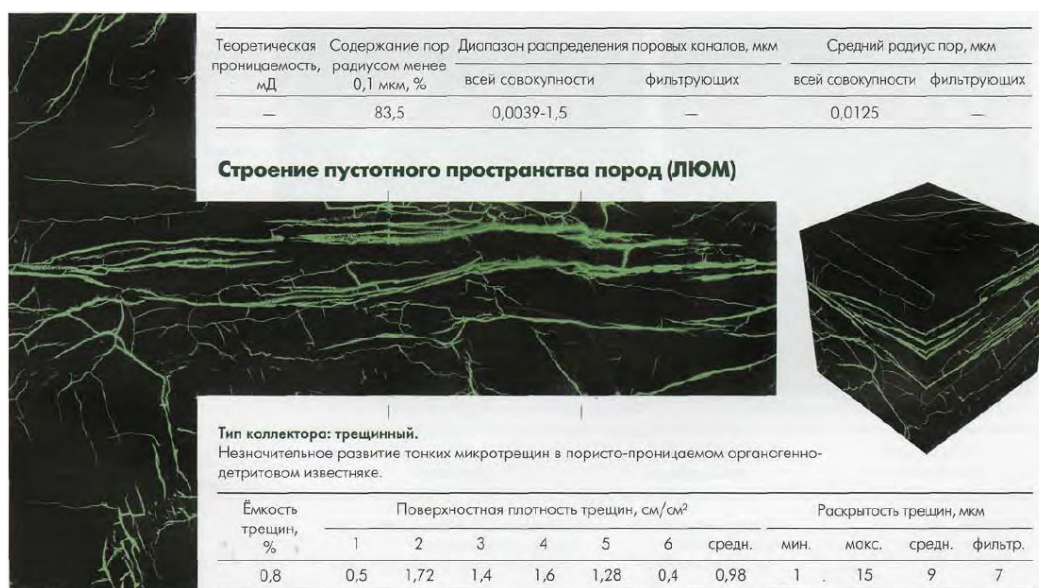
Рисунок 3 – Изучение строения пустотного пространства по методике К. И. Багринцевой (пропитка люминофором) [1]
