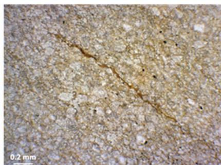
Микротрещина, выполненная битумоидом, в доломите кремнистом, кристаллическом (шлиф 328/61)
