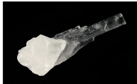
Рисунок 2 – Морфоструктурные особенности калийных руд залежей Петриковского месторождения по материалам исследований технологических проб (класс  $-1,25 + 0,8$  мм)
